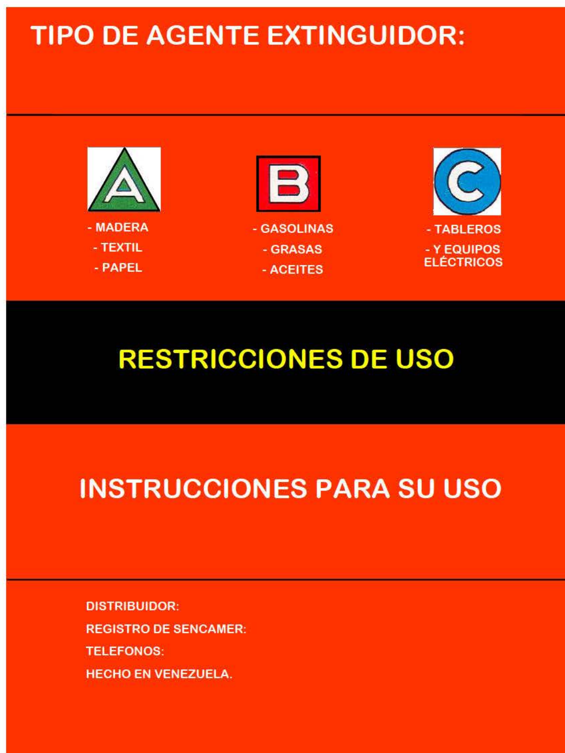
Figura 2A. Ejemplo de etiqueta para extintores
